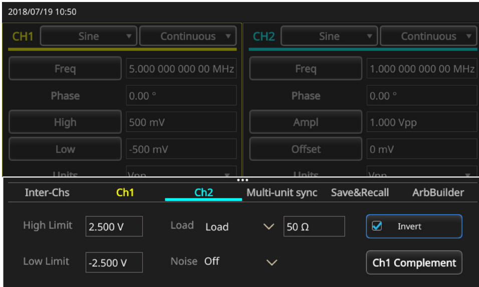
Рисунок 48: Изменение полярности сигнала на канале 2 по сравнению с K1
