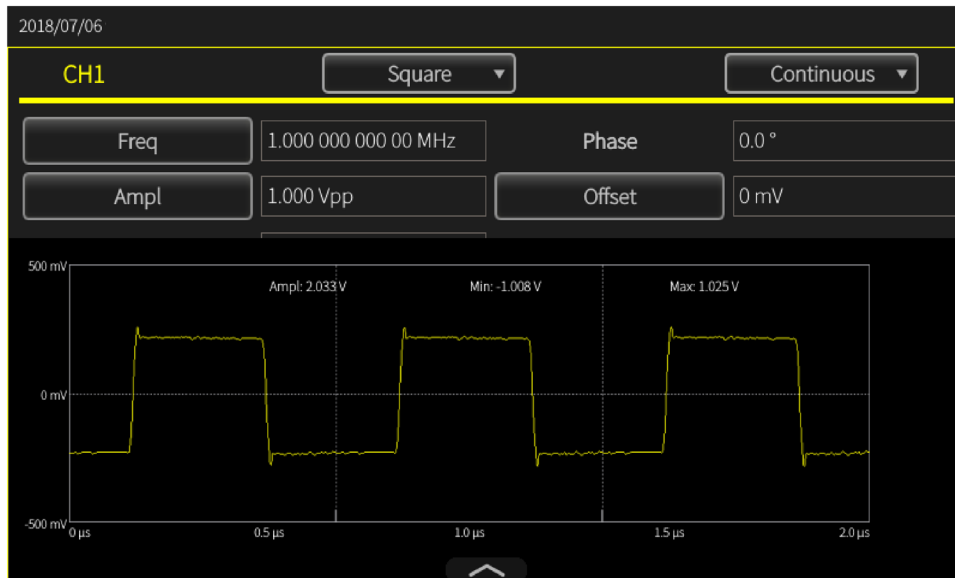
Рисунок 71: Сигнал на входе K1 осциллографа с нагрузкой 1 МОм – InstaView
